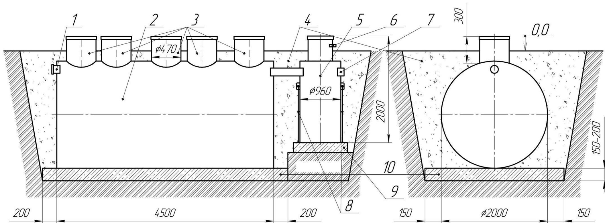
1 – Патрубок входной; 2 – Корпус ЛОС «Биосфера 30»; 3 – Горловины; 4 – Песок уплотненный; 5 – Корпус установки УФО; 6 – патрубок выходной напорный; 7 – Патрубок аварийного слива; 8 – Стропы якорения корпуса УФ установки; 9 – железобетонное основание под УФО; 10 – железобетонное основание под ЛОС
