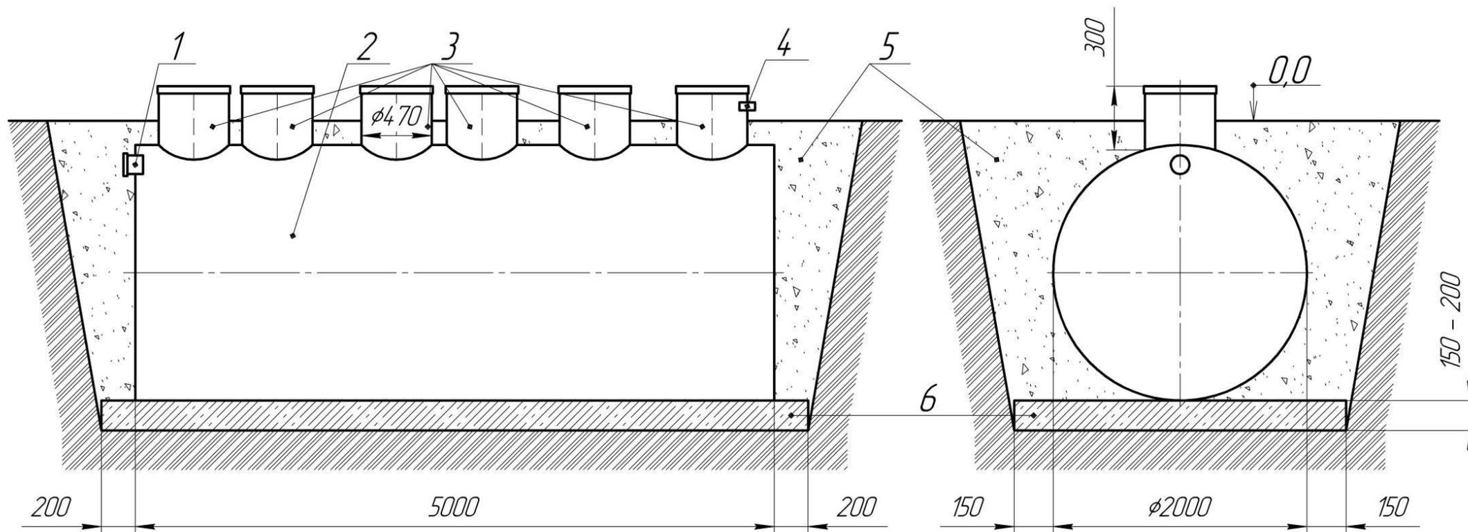
1 – Патрубок входной; 2 – Корпус ЛОС «Биосфера 30»; 3 – Горловины; 4 – Патрубок выходной; 5 – Песок уплотненный; 6 – железобетонное основание
