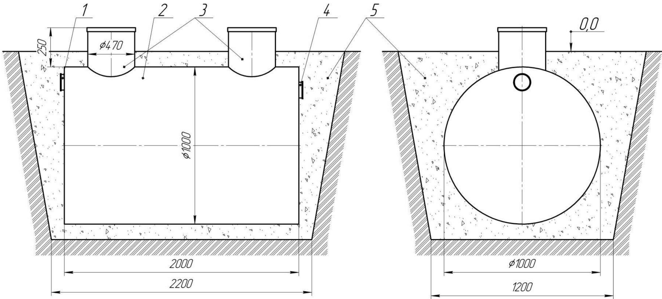
1 – Патрубок входной  $\phi 110$ ; 2 – Корпус септика «Дрена-БИО 5»; 3 – Горловины; 4 – Патрубок выходной  $\phi 110$ ; 5 – Песок крупнозернистый уплотненный
